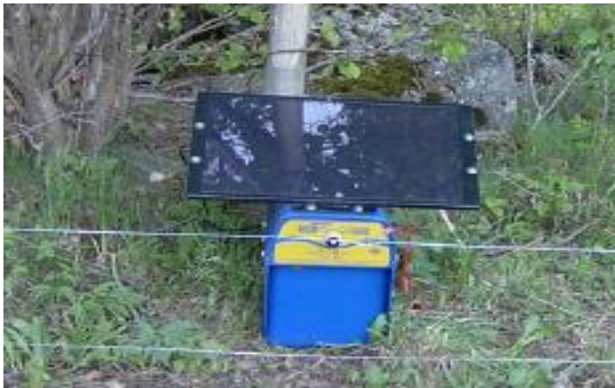
Figura 3.4. Sistema de subministrament d'energia amb bateries i plaques solars.
