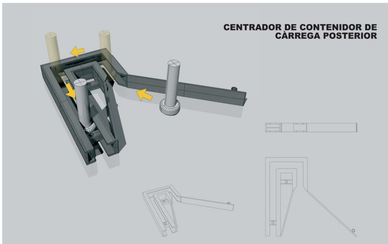
Figura 9.3. Esquema del sistema antibolcat aplicat en contenidors ubicats a Barcelona en zones conflictives per presència de senglar. Font: Ajuntament de Barcelona - CESPA, S.A.
