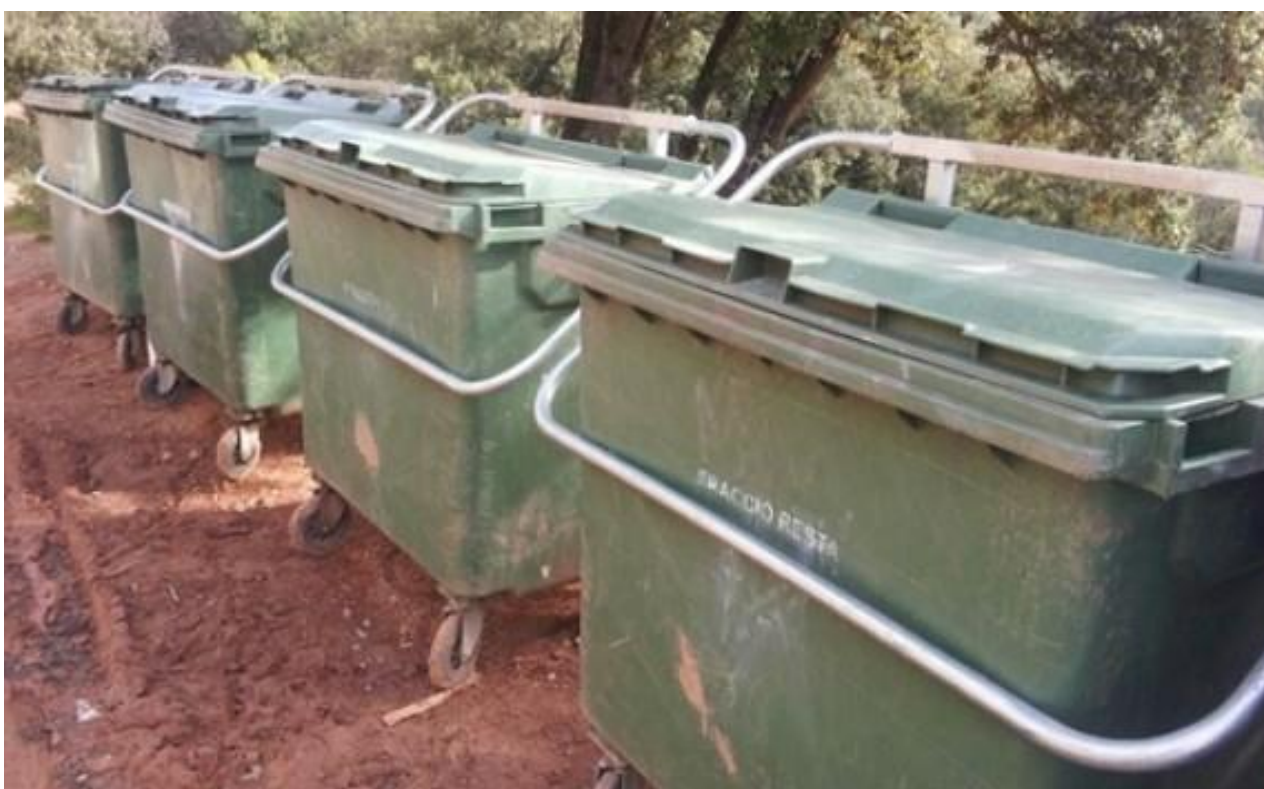
Figura 9.2. Sistema de barres que encerclen els contenidors evitant el bolcat. Font: www.naciodigital.cat .
